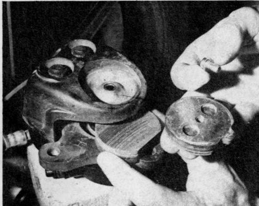
Dépose des plaquettes de frein avant. La plaquette fixe avec un ergot est immobilisée par une vis. (Photo RMT)
